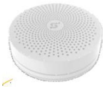
网关整体设计采用 ABS 注塑成型，上下盖通过螺丝锁紧，里面采用 ARM 芯片+蓝牙模块+WIFI 模块+RJ45 网口模块，网关也拥有唯一身份识别码，能够自动扫描区域内的采集盒子设备，并把采集到的数据上传到系统端进行处理。
