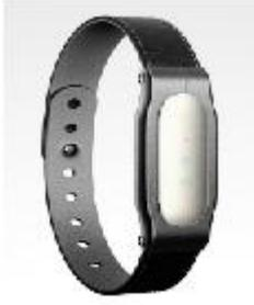
手环采用 IP67 防水设计，由硅胶表带、金属扣、塑胶后盖、及手环主体构成。全部材料为柔软材料设计无棱角，充分考虑了（6-12 岁）学生的好奇心，好动性等不会给孩子的安全带来隐患。手环内部采用了德国 Dialog 公司的 BLE 蓝牙芯片 DA14580 来做主控设计，配合 1620 纽扣电池，待机时间可达一学期以上，完全符合实际使用要求。手环拥有唯一的身份识别码，发放手环时在系统端通过软件可以与学生姓名进行关联，如遇丢失或损坏也可以进行注销与补发操作。手环在设置时间段会把时间、电量和 ID 信息向外广播，大部分时间处于休眠状态以降低功耗。
